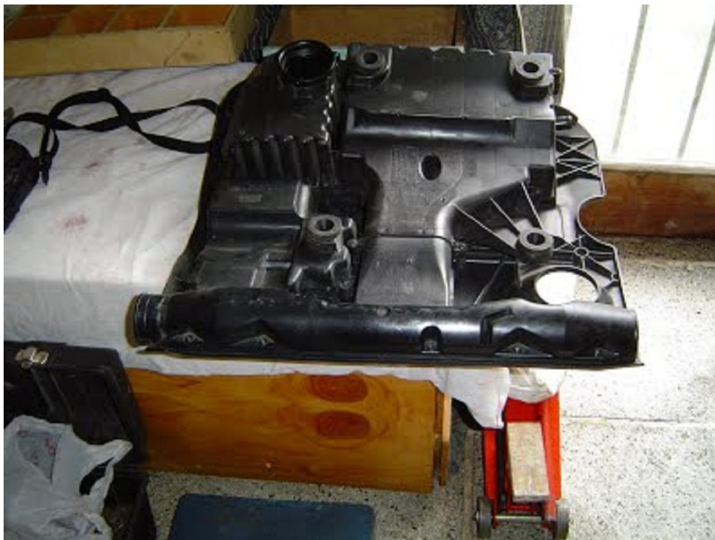
Fig. 5: Tapa superior del motor donde se encuentra el filtro de aire.
